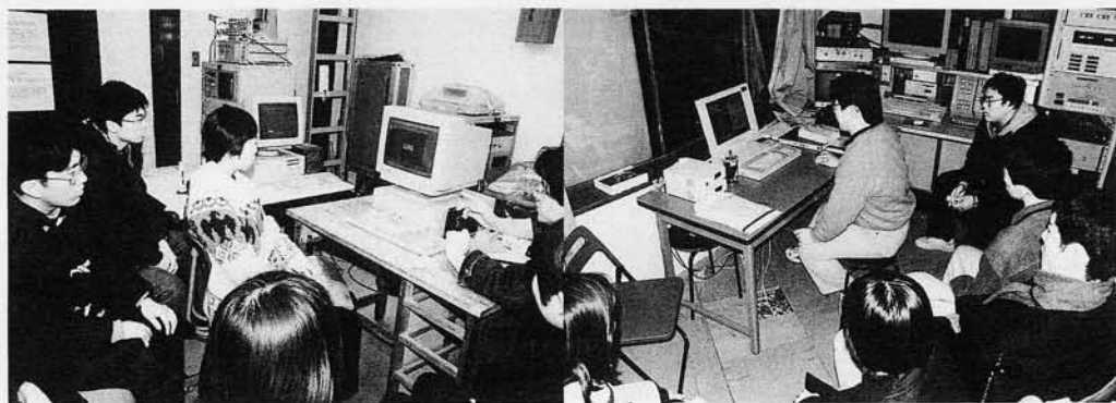
30cm(左)と105cmシュミット(右)の観測の様子。プロ用の望遠鏡は、基本的には天体の導入から撮影まで、すべて望遠鏡から離れた制御室から遠隔操作で行うようになっていた。したがって、観測中は望遠鏡に触れることも、肉眼で天体の姿を見ることもまったくない。
