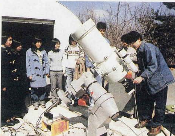
「銀河学校」に使用された望遠鏡は、日本最大の105cmシュミットカメラ(右の写真)と、サブとして30cmカタディオプトリック(上の写真)。ちなみに、30cmは高橋製作所のミューロンで、組み合わされるCCDは武藤工業のCV-16IIと、いずれも市販の製品
